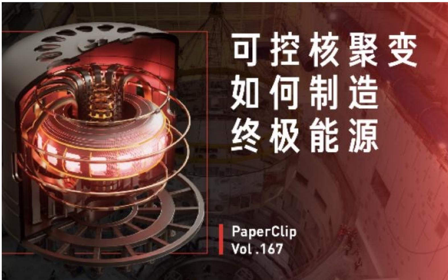
可控核聚变普遍需要使用低温超导材料制作线圈，通电后，利用电流磁效应产生强磁场，可以约束聚变反应中温度高达上亿度的等离子体。
